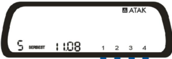
Saat küçük ekranда gösterilir. Küçük ekranı kapatmak için tekrar 3 ve 4 tuşlarına basın.
