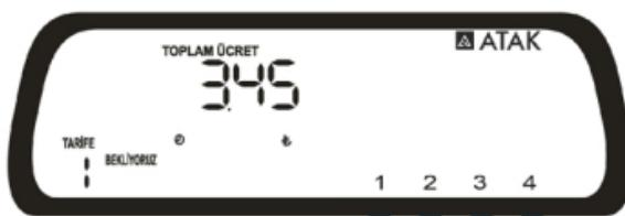
Bu modda taksi hareket etmiyor ve taksimetre yalnızca zamana göre ücretlendiriyor. BEKLEME esnasında ekranada "TARİFE", "BEKLİYORUZ", "TOPLAM ÜCRET" ve "EKSTRA" (ekstra ücret alınmışsa) görüntülenir. Zaman işaretü etkinleştir. ÜCRETSİZ BEKLEME moduna gitmek için 2 tuşuna 3 saniye, ÖDEMENİZ moduna gitmek için 3 tuşuna basın.
