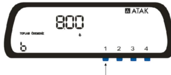
ÖDEMENİZ modundan Tarife "SEYİRDEYİZ", "ÜCRETLİ" veya "ÜCRETSİZ" moduna dönmek için 1 tuşuna basın. Taksimetre, taksi 10 metreden fazla hareket ederse ÖDEMENİZ modundan SEYİRDEYİZ moduna otomatik olarak geçecektir.
