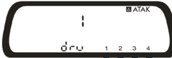
Sürücü seçmek için 1 butonuna basın (sürücü numarası yanıp söner). Örneğin sürücü 3'ü onaylamak için 4 düğmesine basın. Sonra taksimetre, 3. sürücünün kodunu sorar.
