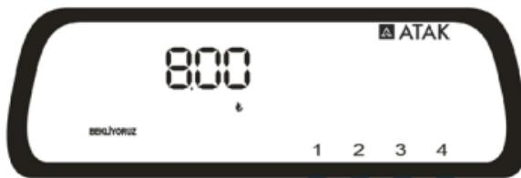
Bu çalışma modunda taksimetre, ne zamana, ne de mesafeye göre ücretlendirme yapmaz. BEKLİYORUZ modunda "BEKLİYORUZ" ibaresi görüntülenir. SEYİRDEYİZ moduna gitmek için 2 düğmesini 3 saniye basılı tutun veya 3 numaralı düğmeye 1 kere basarak ÖDEMENİZ moduna geçin.
